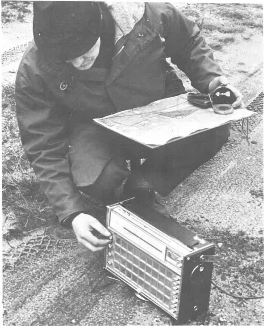
عکس ۶ - تعیین محل روباه با دستگاه گیرنده و مشخص نمودن آن روی نقشه
